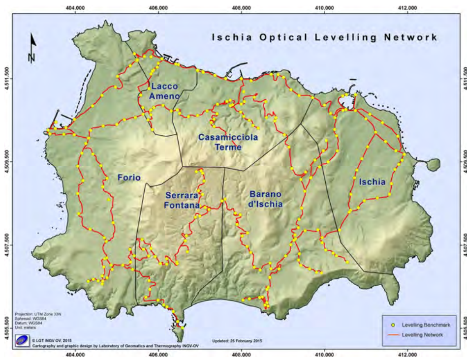
Figura 2-6. Linea di livellazione di precisione all'isola d'Ischia.
